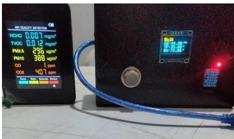
Gambar 14. Pengujian dengan Alat yang Sudah Ada
