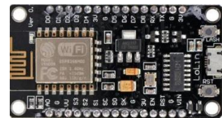
Gambar 1. Node MCU ESP8266
